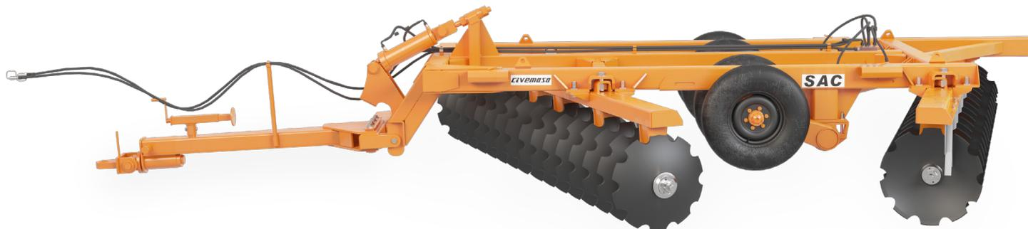
Possuem rodas reforçadas com pneus e cubos individuais e dois cilindros para o acionamento das rodas. O cabeçalho é equipado com gancho de engate reforçado e um cilindro hidráulico com a função de facilitar manobras, transporte e trabalhos operacionais.
